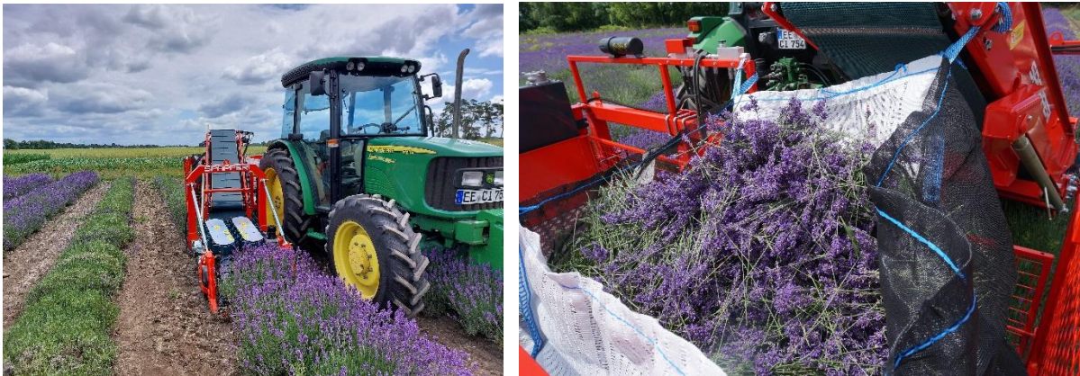
Abbildung 2: Lavendelernte mit halbautomatischem Anbaugerät
