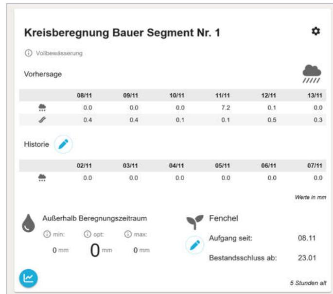
Abbildung 10: Screenshot aus Raindancer. Darstellung der Bewässerungsempfehlung für einen Schlag mit einer Kreisbewässerungsanlage.
