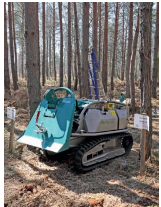
Die multifunktionale Forstraue Moritz Fr50 im Versuchseinsatz, hier bei Leerfahrt ohne Auf- und Anbauten – stellvertretend für Kleintechnik mit ähnlichem Kontaktflächendruck.
