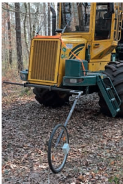
Kabellose Traktionsmessung im Hang – mit externen Beschleunigungssensoren an allen Radachsen.
