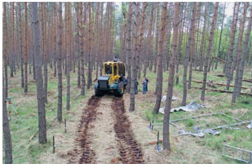
Versuchseinsatz der beiden bauartähnlichen Forwarder in 6-Rad- und 8-Rad-Ausführung.
