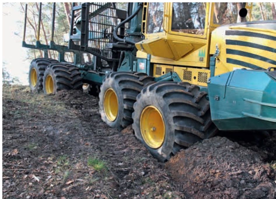
Kabellose Traktionsmessung im Hang – mit externen Beschleunigungssensoren an allen Radachsen.
