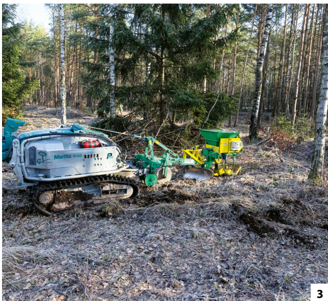
Abb. 3: Verjüngungsverfahren: (1) Kleinraupe mit Sä-Fräskombination, (2) Säeinheit, (3) Unterbaupflug und Sämaschine, (4) Einscheibenpflug „Wildsau P1T“, (5) Waldbauharvester und (6) Referenzpflanzung (Fotos: R. Köhler, M. Harbusch)
